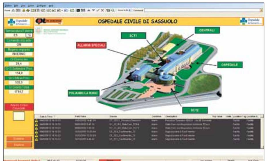
■ Home page del sistema di supervisione Honeywell installato dal Settore ICT di CPL: al software di supervisione confluiscono sia la gestione delle nuove centrali sia la termoregolazione dei locali tecnologici non riqualificati
